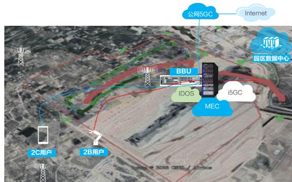
图 3-9 室外作业区 5G 现场网部署模式示意图
