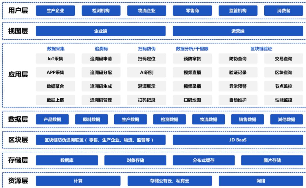
图 48 智臻链防伪追溯平台架构图
