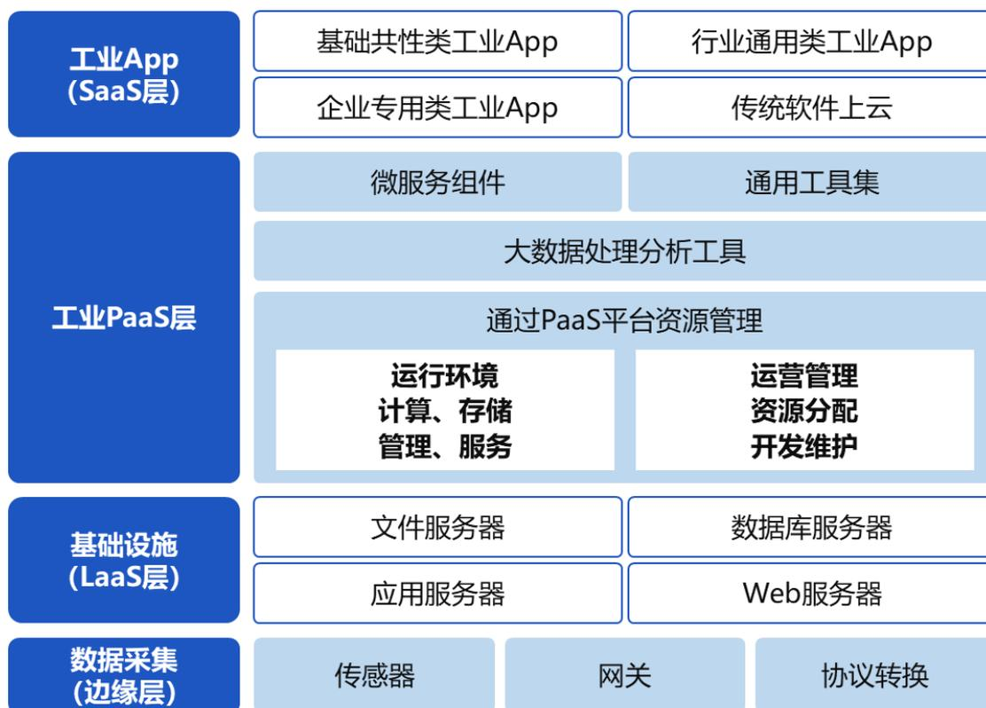
图 20 工业互联网平台架构图
