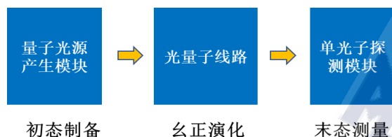
图 13 逻辑门光量子计算原理示意图
