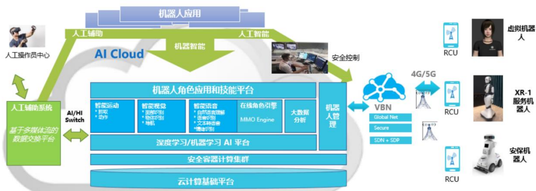
图 14 云-网-端融结合的智能机器人系统架构
